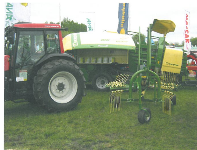
4. kép A kisebb termőterületen gazdálkodók jól használható gépei az egyrotoros Krone rendrakó, háttérben a nagyteljesítményű szögletes nagybálázóval
