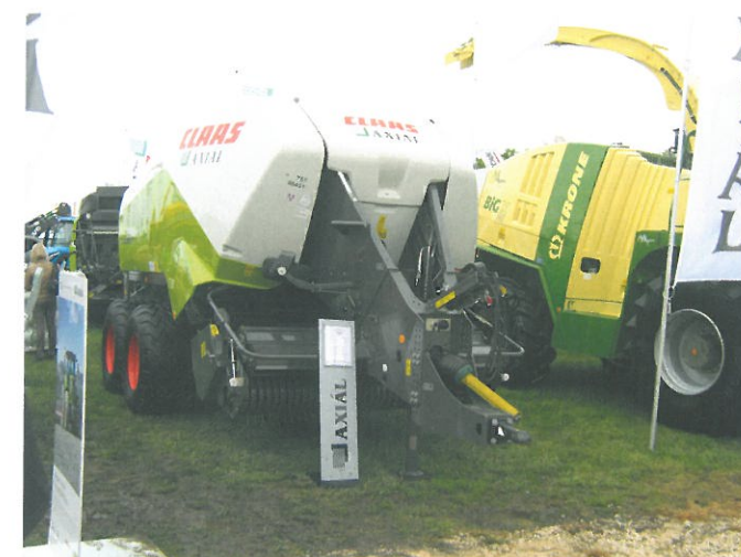
5. kép Az új fejlesztésű széletelővel szerelt szögletes nagybálázó
