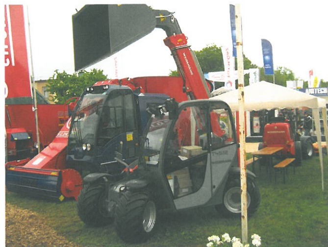
6. kép A T 4512 Weidemann teleszkópos rakodó kis mozgás helyigényénél fogva az állattartó épületekben is biztonságosan mozog
