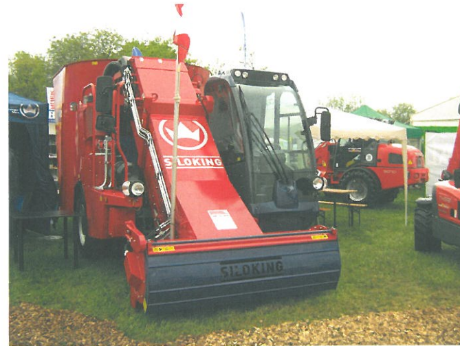
7. kép A vertikális keverő berendezéssel szerelt magajáró Silo King a nagyhozamú tehenészetek célgépe
