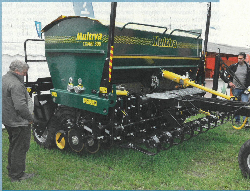
Multiva Combi vetőgép, amelyet Finnországban készítenek. E gépek jellemzője a pontos és rugalmas vetési technológia
