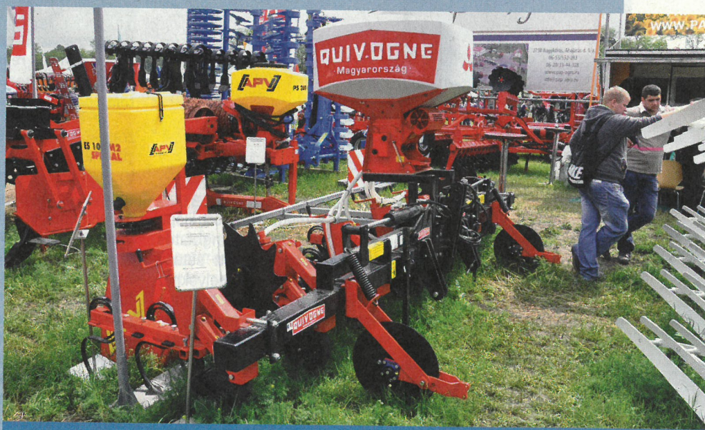
Erősített vázzal, segédrugós művelőelemekkel és műtrágyaszóróval szerelt sorközművelő kultivátor
